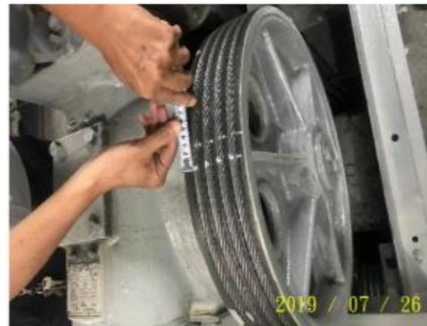
相片 1：牽引機驅動輪滑距測試 30 mm
